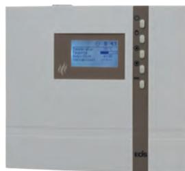
Elektr. Steuerung für Sauna- und Feuchtebetrieb. Stufenlose Regelung zw. 30 und 70 °C im Feuchtebetrieb bzw. 40 – 115 °C im Saunabetrieb. Heizzeitbegrenzung 6 h (12 h), Schaltleistung Ofen 9 kW (erweiterbar mit LSG), Verdampfer 3 kW. 5-Stufen-Feuchteaktung mit Wassermangelerkennung und Nachheizfunktion. Digitale Anzeige der Uhrzeit, Temperatur, Feuchte und Restlaufzeit.
