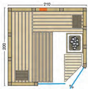
**Abbildung Classico Tanne mit Sonderausstattung:** Eckeinstieg mit Tür ohne Schwelle, großes Glaselement, Inneneinrichtung Linea, VITALlight-IPX4-Strahler mit Rückenpolster, LED-Beleuchtung, Verdampferofen Hotline S8, Steuerung Saunacontrol T4.
