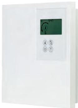
Elektr. Steuerung für finnische Sauna mit LCD-Anzeige. Stufenlose Regelung zw. 70 und 115 °C, Heizzeitbegrenzung 6 h, Schaltleistung 9 kW. Anzeige der Temperatur und Restlaufzeit. Temperaturfühler mit Kabel (3 m) inkludiert, Sicherheitstemperaturbegrenzung bei 141 °C, Licht Ein/Aus.
