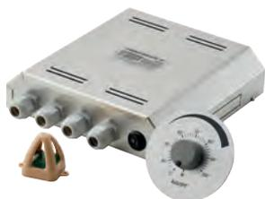
Bedienungsfreundliche Steuerung für finnische Sauna. Die stufenlose Regelung zw. 40 und 105 °C erfolgt nur über einen Drehregler, der im Inneren oder außerhalb der Sauna montiert werden kann. Heizzeitbegrenzung 6 h, Sicherheitstemperaturbegr. bei 128 °C, Schaltleistung 11,0 kW (erweiterbar mit LE1). Sehr kleines Bedienteil, externe Steuerungsbox, Temperaturfühler mit Kabel (3,5 m) inkludiert, Licht Ein/Aus, Lüfterfunktion.
