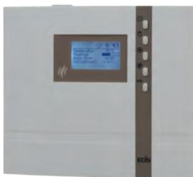
Elektr. Steuerung für finnische Sauna mit großer LCD-Anzeige. Stufenlose Regelung zw. 30 und 115 °C, Heizzeitbegrenzung 6 h (12 h), Schaltleistung 9 kW (erweiterbar mit LSG), Uhrzeit, Temperatur und Restlaufzeit, Tastensperre / Kindersicherung, Temperaturfühler mit Kabel (2 m) inkludiert, Sicherheitstemperaturbegrenzung bei 139 °C, Licht Ein/Aus.
