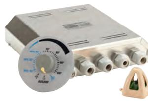
Bedienungsfreundliche Steuerung für Sauna- und Feuchtebetrieb bis 11,0 kW (erweiterbar mit LE1). Sehr kleines Bedienteil, inner- oder außerhalb der Sauna montierbar. Stufenlose Regelung zw. 65 – 35 % und 35 – 65 °C im Feuchtebetrieb bzw. 65 – 105 °C im Saunabetrieb. Heizzeitbegr. 6 h, Sicherheitstemperaturbegr. bei 128 °C. Externe Steuerungsbox, Fühlerbank mit Kabel (3,5 m), Licht Ein/Aus, Lüfterfunktion.
