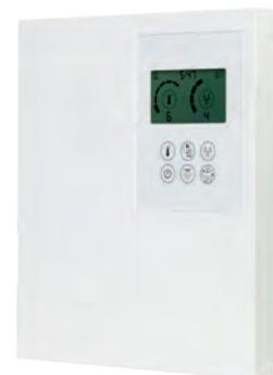
Elektr. Steuerung für Sauna- und Feuchtebetrieb. Stufenlose Regelung zw. 33 und 65 °C im Feuchtebetrieb bzw. 70 – 115 °C im Saunabetrieb. Heizzeitbegrenzung 6 h, Schaltleistung Ofen 9 kW, Verdampfer 3 kW. 9-Stufen-Feuchteaktung mit Wassermangelerkennung und Nachheizfunktion. Anzeige der Temperatur und Restlaufzeit. Temperaturfühler mit 3 m Kabel, Sicherheitstemperaturbegrenzung bei 141 °C, Licht Ein/Aus.
